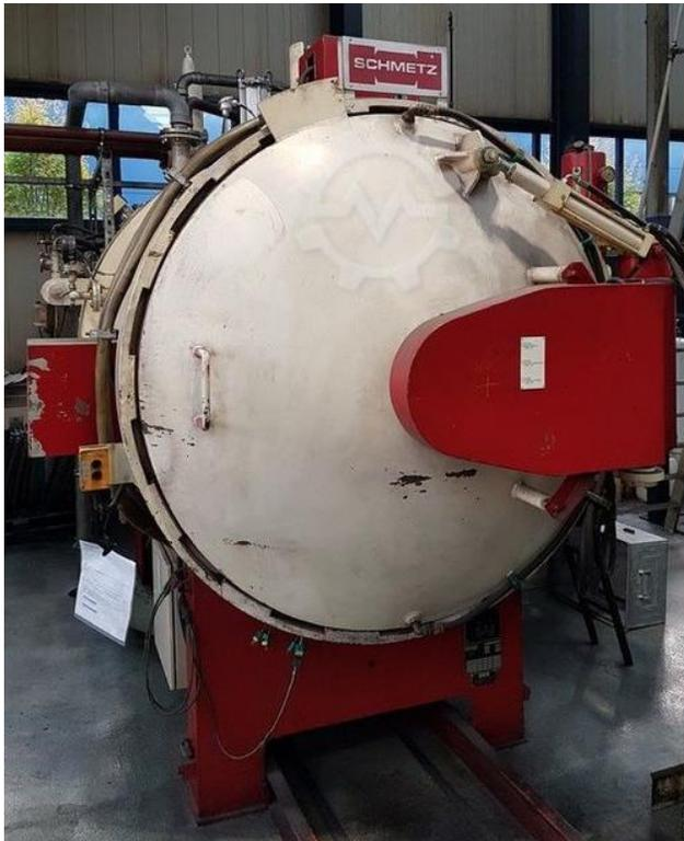
Nutzraum: 600 x 900 x 600 mm B x L X H, Druck 6 bar , Temperatur: 1.350 °C
